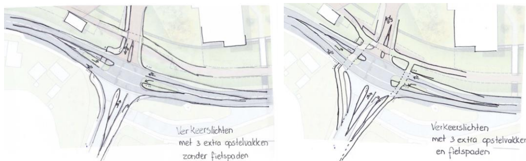
Afbeelding 5.3.: onderzoeksschets inpassing verkeerslichten hoofdontsluiting Kloos (bron: Bosch Slabbers)
