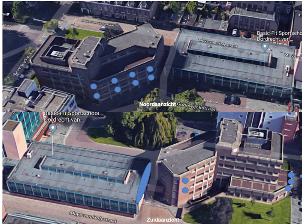
Figuur 2 De gebouwen op de planlocatie bieden vleermuizen een geschikte verblijfslocatie. Op diverse locaties zijn open stootvoegen aanwezig, bij het gebouw van Basic fit is sprake van een kier.
