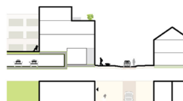
De maximale bouwhoogte kan alleen worden gebouwd wanneer er een verjonging plaatsvindt ... ten opzichte van het Geldeloze pad.
