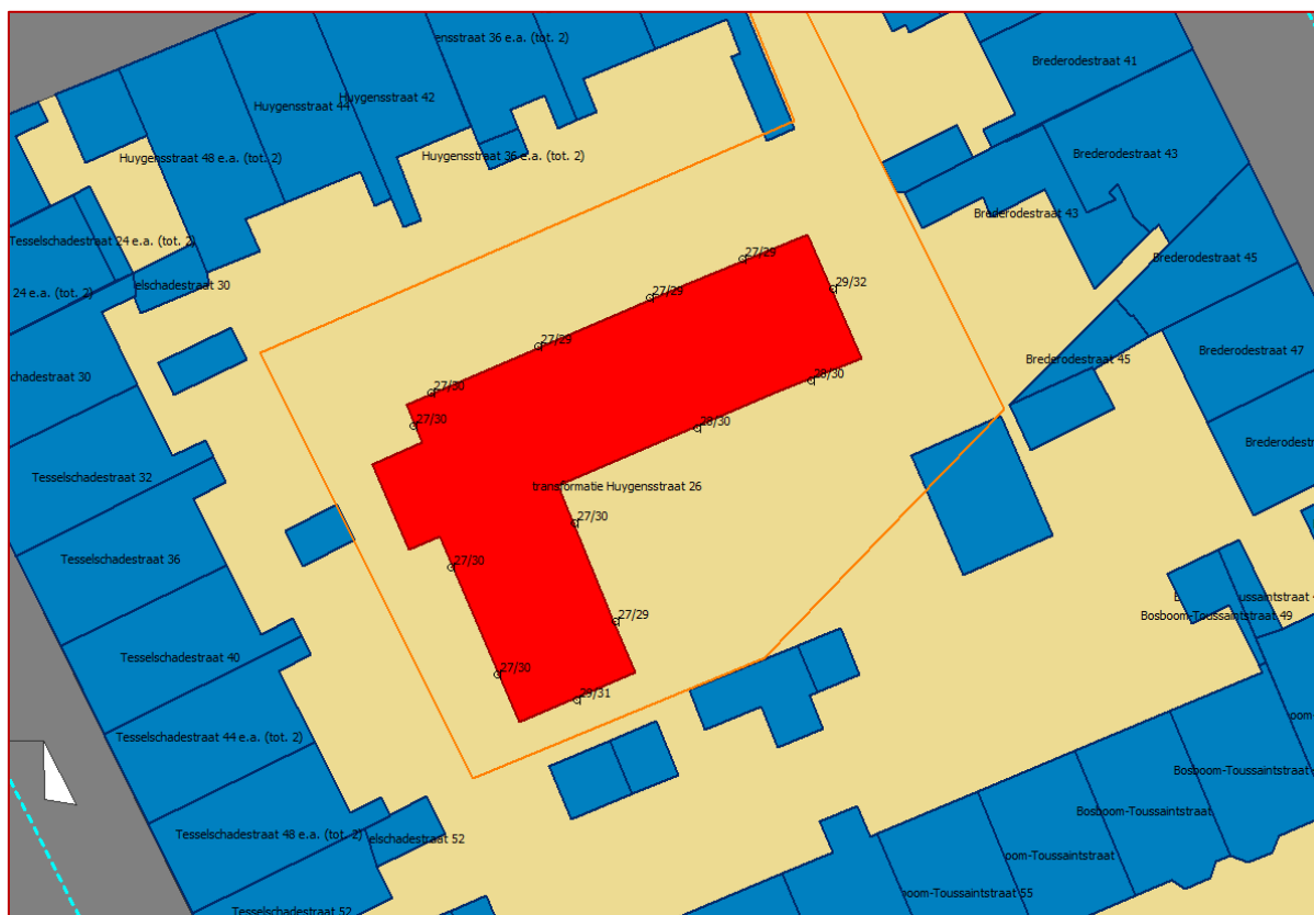
Figuur 4.4: Rekenresultaten vanwege cumulatie 30 km/u in de omgeving van de planlocatie, inclusief 5 dB aftrek ingevolge art. 110g Wgh.
