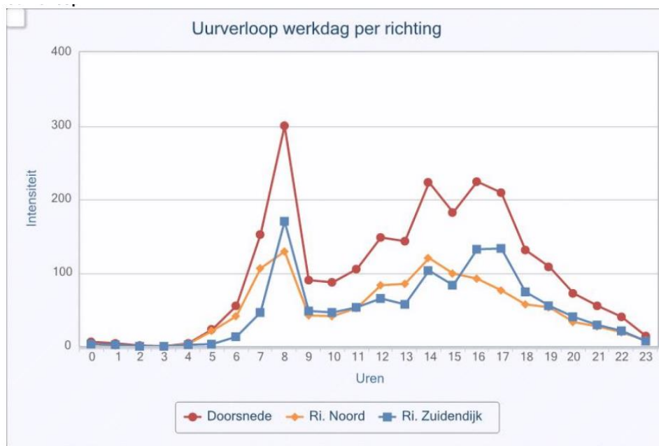
Figuur 7 Verkeersintensiteit op overweg Zuidendijk (september 2019).
