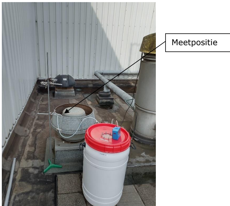
Figuur 2.8 Foto van de meetsituatie van de ruimteventilatie malerij
