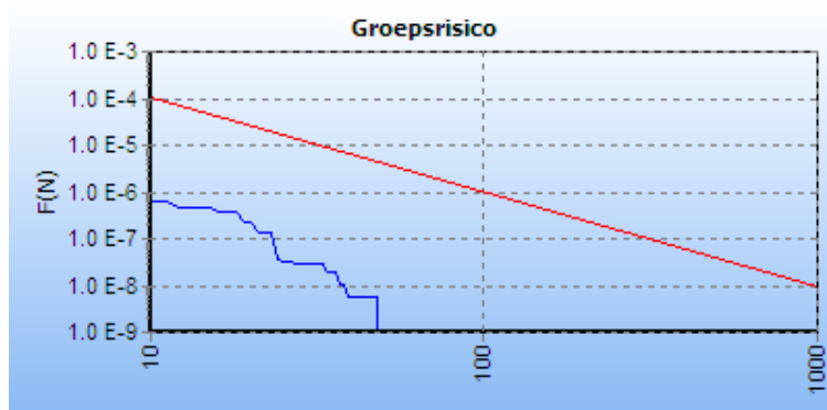
Figuur 5.4 FN curve voor W-507-02 van N.V. Nederlandse Gasunie voor de kilometer tussen stationing 0.00 en stationing 1000.00
