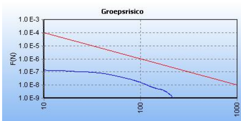
Figuur 5.2 FN curve voor 1477_leiding-A-555-deel-1 van N.V. Nederlandse Gasunie voor de kilometer tussen stationing 4750.00 en stationing 5750.00
