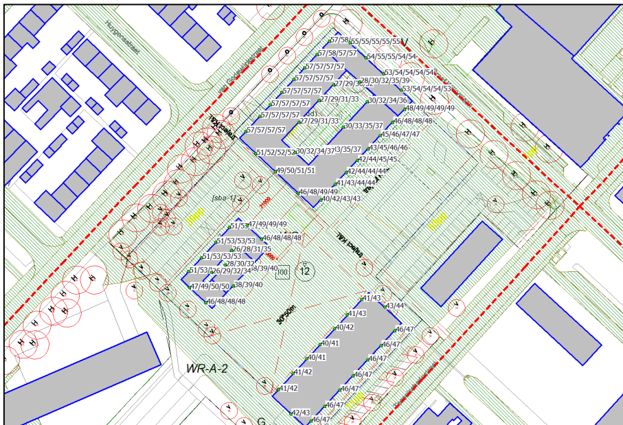
Figuur 5.1 Gecumuleerde geluidbelasting
