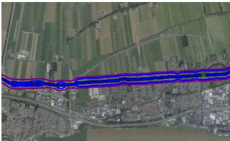
Afbeelding 4.5: Plaatsgebonden risico voor gasleiding W-521-01 excl. verl.
