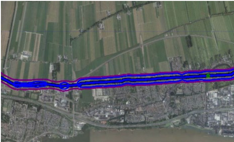
Plaatsgebonden risico voor gasleiding W-521-01 incl. verl.
