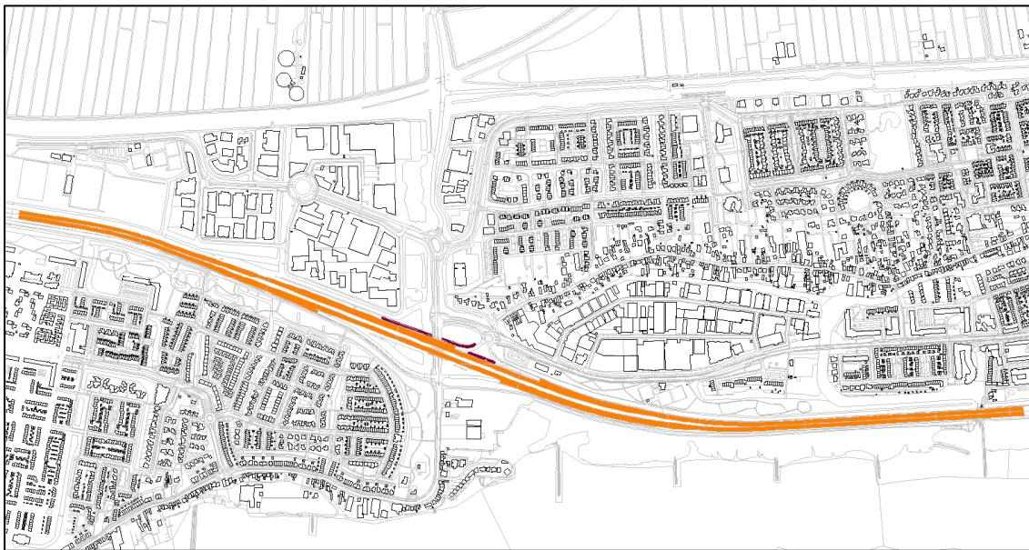
Afbeelding 10 Wegvak (oranje) met 2LZOAB binnen 2 x 2D-zichthoek en nieuw geluidsschermen (paars) met een totale lengte van 310 meter en een hoogte van 6,0 meter
