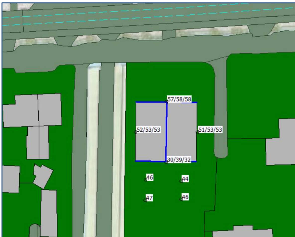
Afbeelding 7. Geluidbelastingen Lden (incl. aftrek art. 110g Wgh) Parallelweg Berekende geluidbelastingen op een hoogte van 1,5 / 4,5 / 7,5 meter boven het maaiveld
