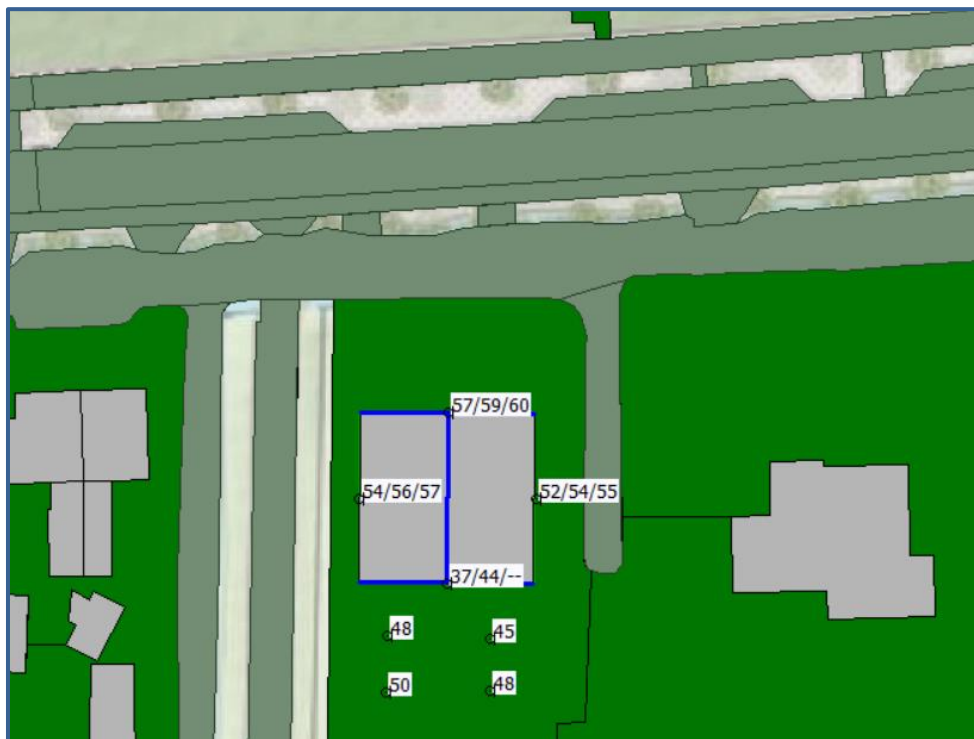
Afbeelding 6. Geluidbelastingen L_{den} spoorlijn Merwede-Lingelijn Berekende geluidbelastingen op een hoogte van 1,5 / 4,5 / 7,5 meter boven het maaiveld
