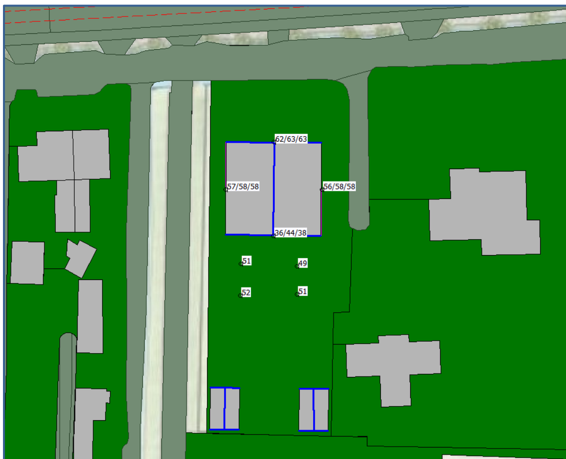
Afbeelding 11. Geluidbelastingen Lden (exclusief aftrek art. 110g Wgh) Cumulatief wegverkeer Berekende geluidbelastingen op een hoogte van 1,5 / 4,5 / 7,5 meter boven het maaiveld
