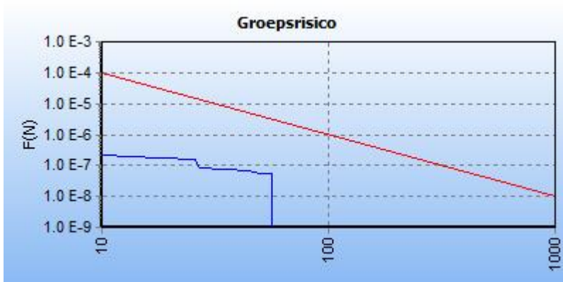
5.2 Figuur 5.2 FN curve voor 8939_leiding-W-528-08-deel-1 van N.V. Nederlandse Gasunie voor de kilometer tussen stationing 0.00 en stationing 800.00
