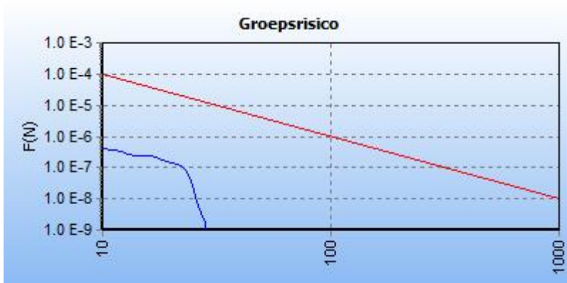
5.2 Figuur 5.2 FN curve voor 8939_leiding-W-528-08-deel-1 van N.V. Nederlandse Gasunie voor de kilometer tussen stationing 0.00 en stationing 800.00
