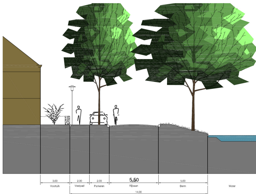
Profiel langs het water (met talud)
