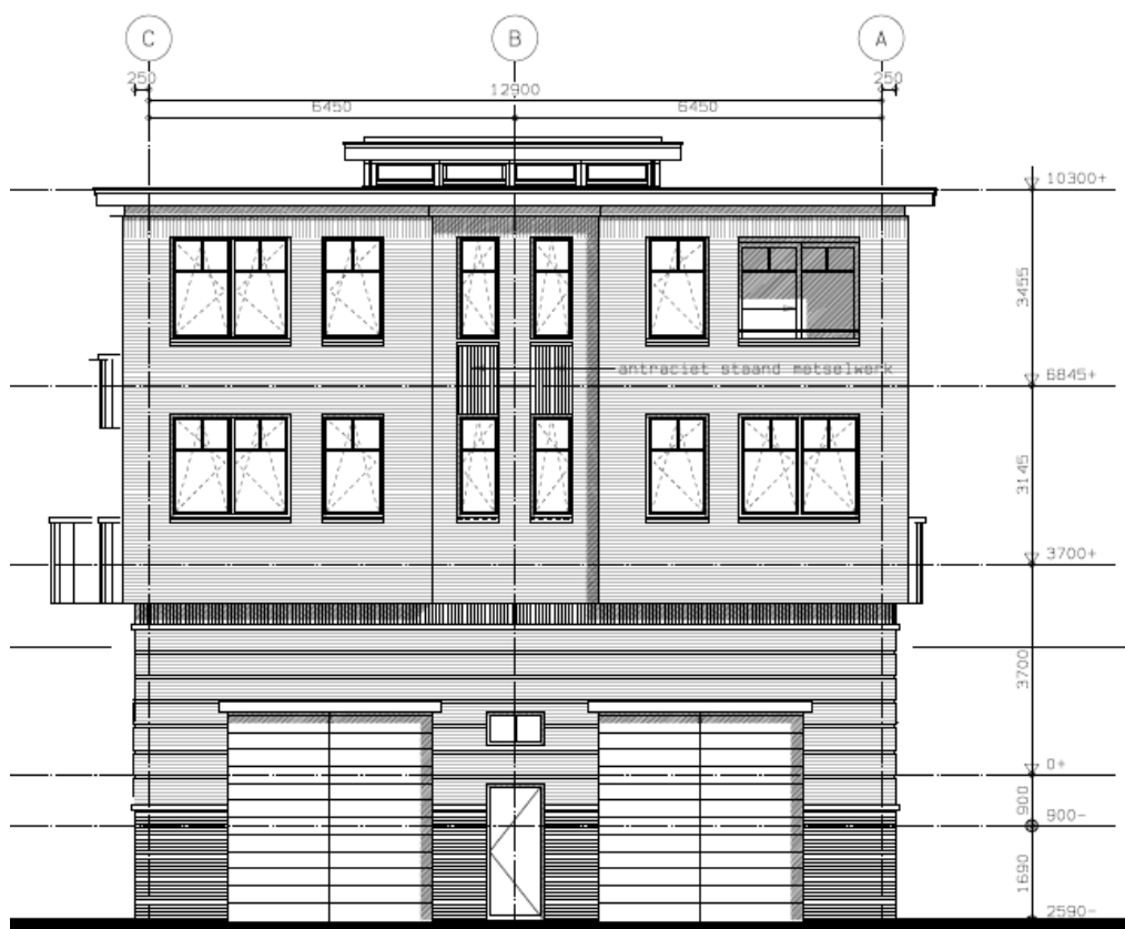
Afbeelding 6: Achtergevel nieuw pand
