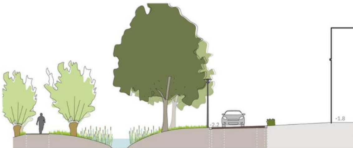
Figuur 17. Principe inrichting van een straat op één oor richting de watergang.
