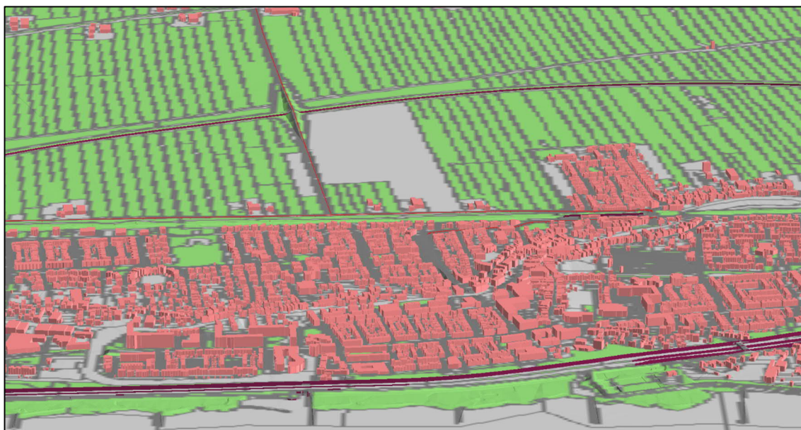
Figuur 3 3D-weergave computersimulatiemodel wegverkeerslawaai - contourberekeningen en bestemmingsgrens
