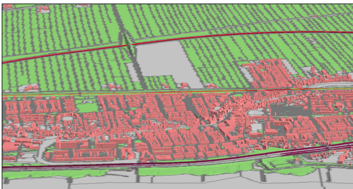
Figuur 4 3D-weergave computersimulatiemodel railverkeerslawaai - contourberekeningen en bestemmingsgrens
