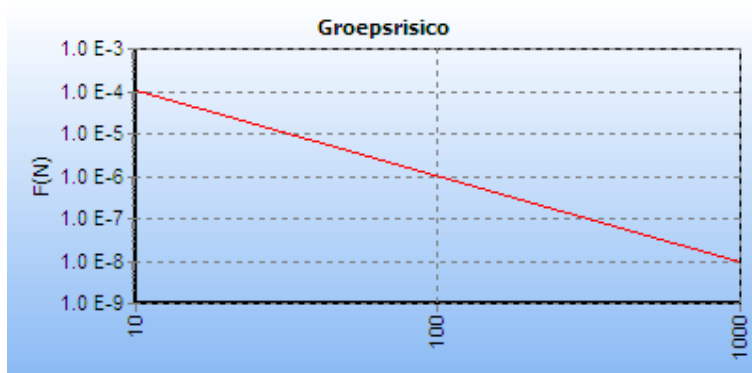
5.2 Figuur 5.4 FN curve voor W-530-01 van N.V. Nederlandse Gasunie voor de kilometer tussen stationing 2370.00 en stationing 3370.00
