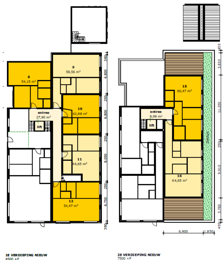
Afbeelding 8: Beoogde situatie 1 e en 2 e verdieping
