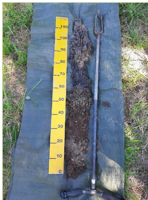
Detail profiel, blauwverkleuring vanaf 60 cm beneden maaiveld goed zichtbaar.
