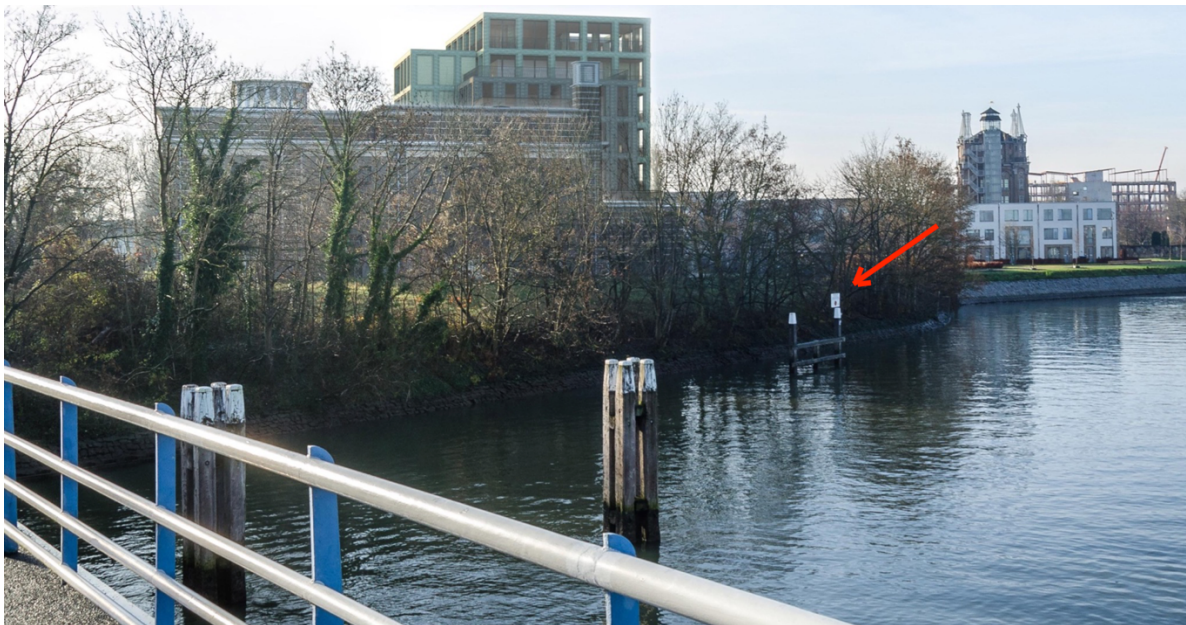
Afbeelding 3: Wachtplaats klasse I, met drukknop voor aanvraag brugbediening op de achterste paal.
