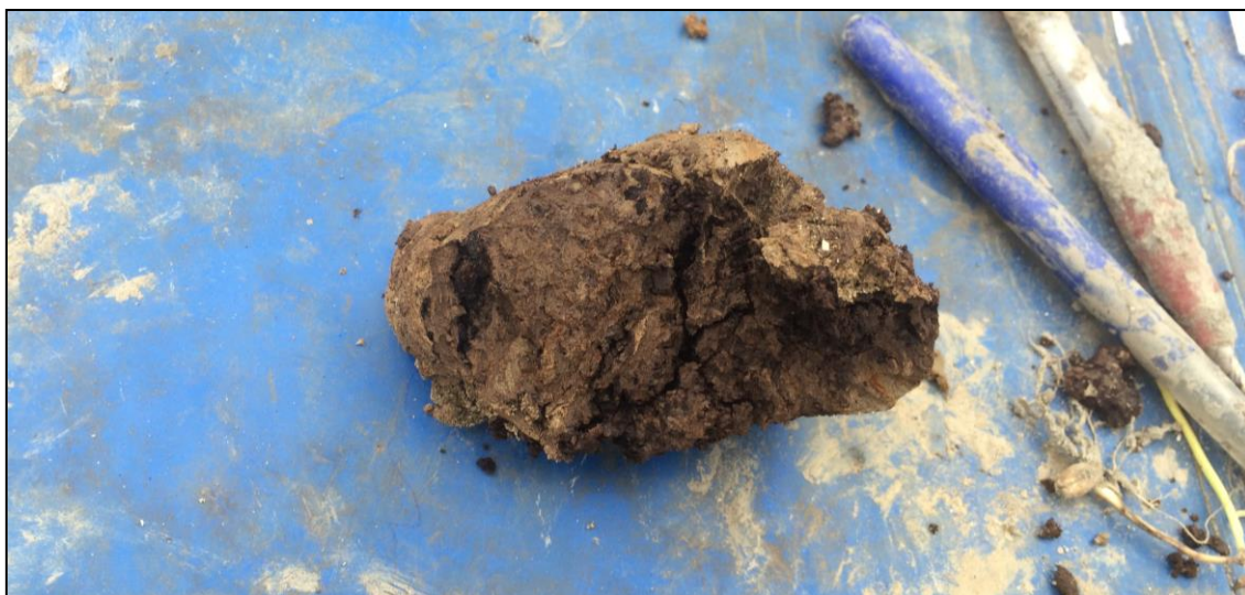
Figuur 13: Doorgebroken kern van een monster tussen 120 en 130 cm -Mv in boring 1. Hierin is het sterk gebrokte karakter van het sterk kleiig veen te zien.
